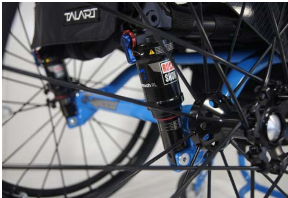
Suomalainen pyörätuolivalmistaja Talart valmisti Rock Shox –alamäkipolkupyörän iskunvaimentimilla ja frog leg –joustohaarukoilla olevan yksilöllisen pyörätuolin paralympiamitalisti Henry Mannille. Kuva: Henry Mannin albumi
