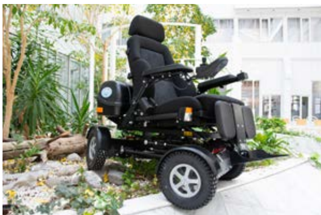
Esprit Action -kevytsähköpyörätuolin teknologia tunnistaa kallistumat, hidastaa vauhtia automaattisesti ja vähentää kaatumisriskiä. Kuva: Camp Mobility
